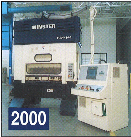
MINSTER P2H-100 112-TON DOUBLE-CRANK S.S. PRESS
